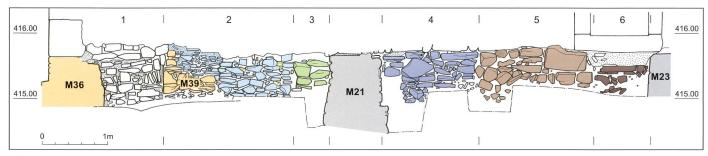
Abb. 23: Freienbach, Ufnau, St. Peter und Paul, 2007, Mauer M8, steingerechte Aufnahme der Aussenansicht des in Etappen errichteten Fundamentes, von Süden.
