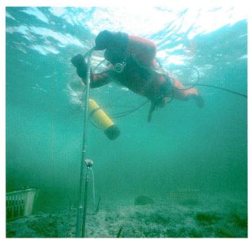
Abb. 15: Ein Taucher führt eine Kernbohrung aus.
