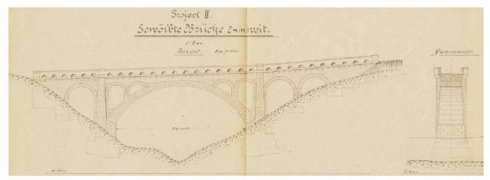
Abb. 2: Ausschnitt aus Kunstbauten-Plan für Strasse Muotathal–Richisau, Ingenieure Müller und Zeerleder, Zürich, um 1906. Die geplante 24 m lange Brücke – sie erinnert an das Steinstafelviadukt der Furka-Oberalp-Bahn – war Teil des ersten Pragelstrassen-Projekts im eigentlichen technischen Sinn, welches zudem einen Abzweiger Pragel–Wägital beinhaltete. Der Bundesrat lehnte aber 1909 eine Subventionierung ab.
