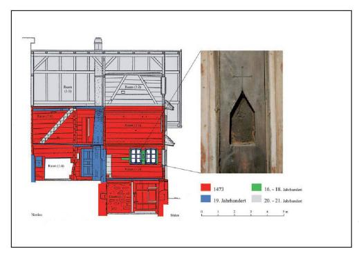
Abb. 13: Längsschnitt gegen Osten, mit kreuzdekorierter Nische im Pfosten der nachträglich eingebrachten Fenster in der Ostwand der grossen Stube (1.2).
