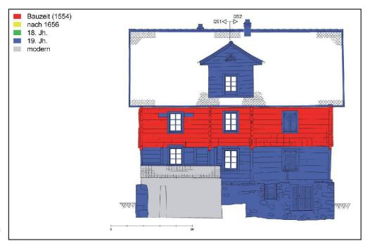
Abb. 9: Westfassade, die originalen Strukturen sind rot gefärbt.
