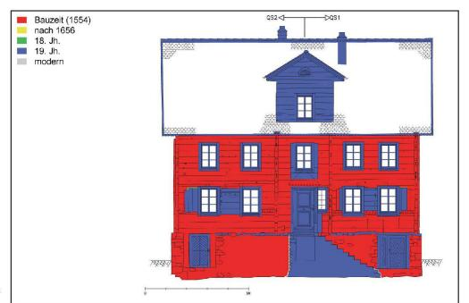
Abb. 13: Ostfassade, die originalen Strukturen sind rot gefärbt.
