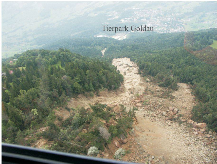
Ein grosser Teil des Materials der Felsrutschung vom 22. August 2005 floss murgangähnlich, aber äusserst langsam, bis in den besiedelten Talboden beim Tierpark Goldau. Dabei hinterliess er eine Spur der Verwüstung.
