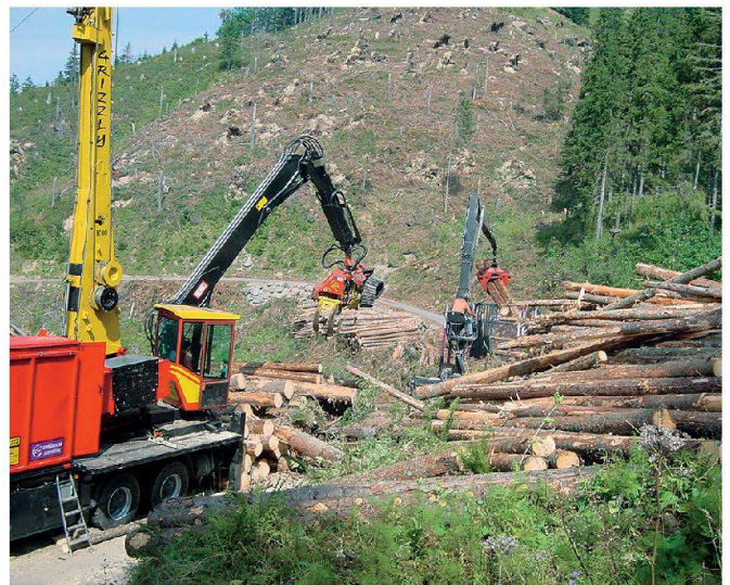
Abb. 27: Moderne Holzerntemaschine (Gebirgs harvester).
