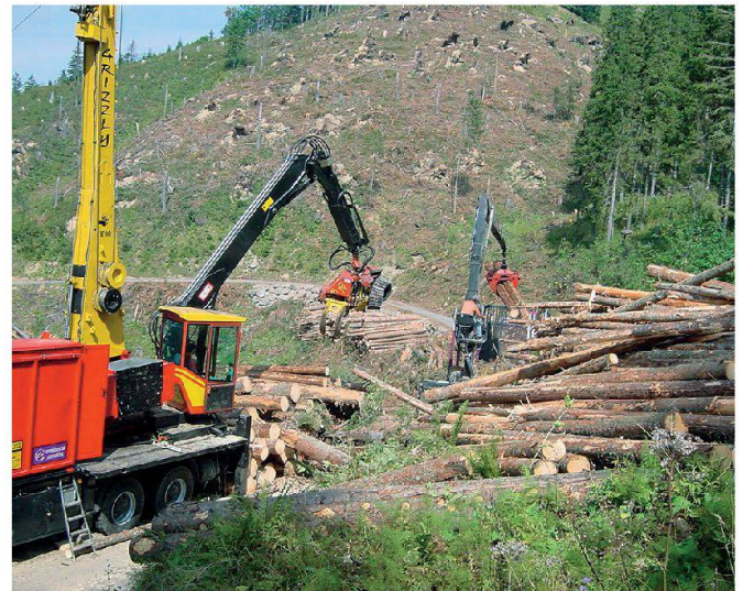
Abb. 27: Moderne Holzerntemaschine (Gebirgsarvester).
