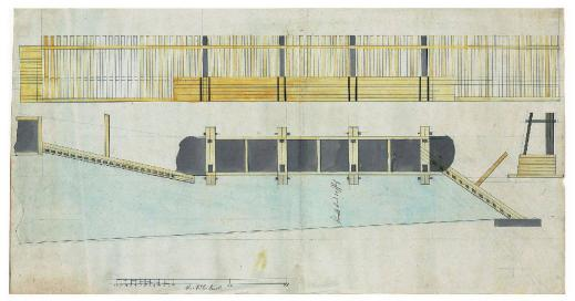
Abb. 8: Die Querschnittzeichnung des Rechens macht die massive Bauweise deutlich. Dies war auch nötig: Bei Hochwasser und im Frühling bei der Schneeschmelze, wenn sich Holz und sogenannte «Eisschoren» stauten, wirkten ungeheure Kräfte auf den Rechen ein (Klosterarchiv Einsiedeln).
