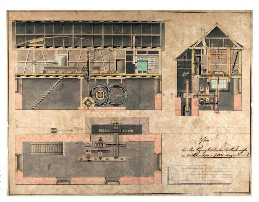
Abb. 2: Plan des Sägereigebäudes bei der Klostermühle an der Alp. Die um 1788 erbaute Sägerei wurde 1833 abgerissen (Klosterarchiv Einsiedeln).
