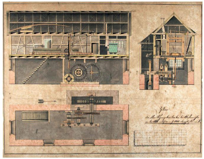
Abb. 3: Plan des alten Sagengebäudes bei der Klostermühle an der Alb, welches im J[ahre] 1833 abgeschlissen wurde, um 1800 (Klosterarchiv Einsiedeln).
