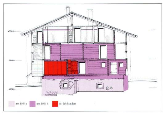
Abb. 44: Querschnitt gegen Norden, die ursprünglichen Bauteile sind violett angelegt.
