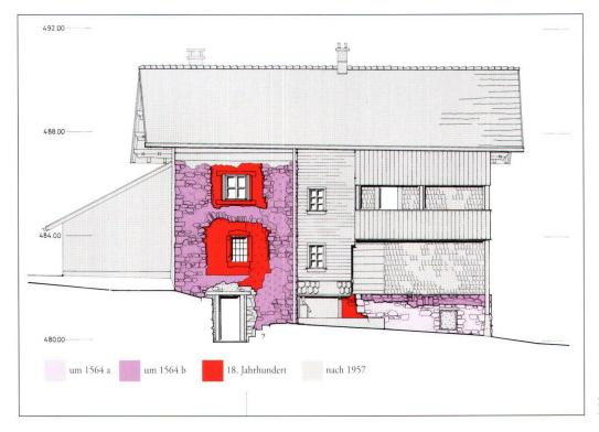
*Abb. 22:* Westfassade, die ursprünglichen Bauteile sind violett angelegt.
