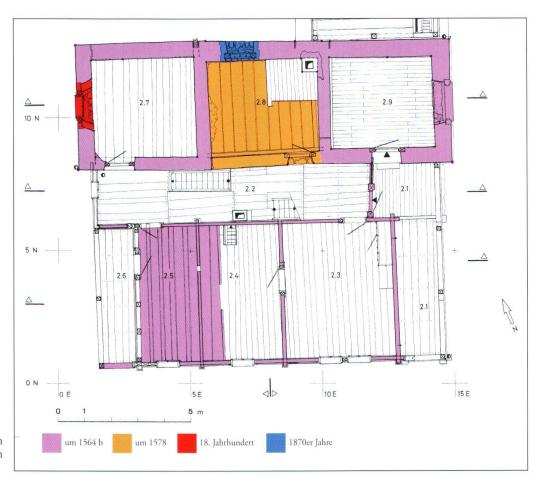
Abb. 37: Grundriss des zweiten Obergeschosses, die ursprünglichen Bauteile sind violett angelegt.
