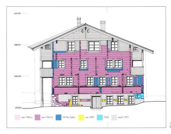
Abb. 17: Südfassade, die ursprünglichen Bauteile sind violett angelegt.
