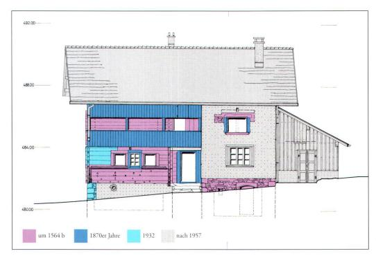
Abb. 20: Ostfassade, die ursprünglichen Bauteile sind violett angelegt.
