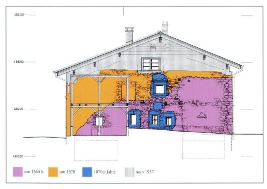
Abb. 24: Nordfassade, die ursprünglichen Bauteile sind violett angelegt.
