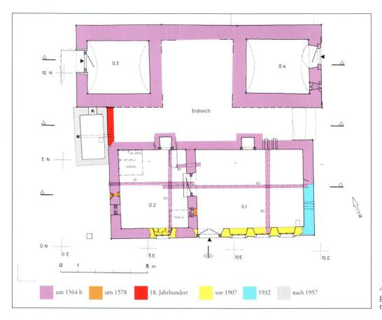
Abb. 25: Grundriss des Erd-/Kellergeschosses, die ursprünglichen Bauteile sind violett angelegt.
