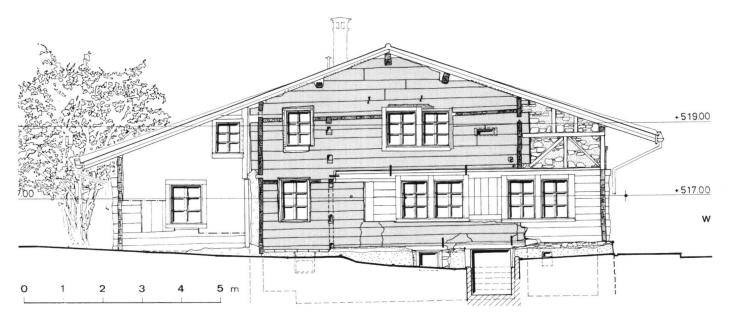
Abb. 2: Nordfassade. Die ursprünglichen Bauteile des Kernbaus sind gerastert.
