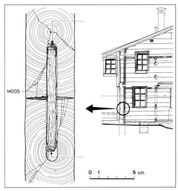
Abb. 35: Nordostecke des Kernbaus: Ausschnitt des sekundär abgesägten Eckgewätts zeigt einen Holzdübel, der zwei Balken der Blockwand zusammenhält.
