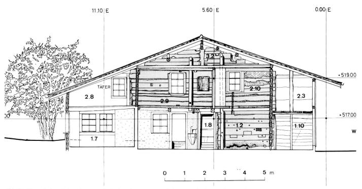
Abb. 12: Querschnitt mit Ansicht gegen die Südwand. Die ursprünglichen Bauteile des Kernbaus sind gerastert.
