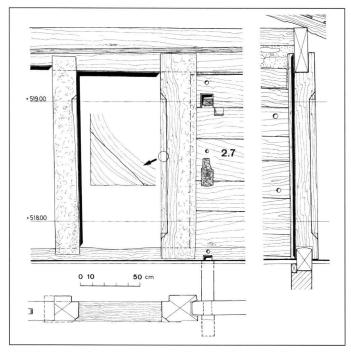
Abb. 5: Ostfassade des Kernbaus: mittlere Türöffnung im Obergeschoss.
