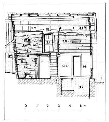
Abb. 9: Westliche Innenwand des Kernbaus. Die ursprünglichen Bauteile sind gerastert.
