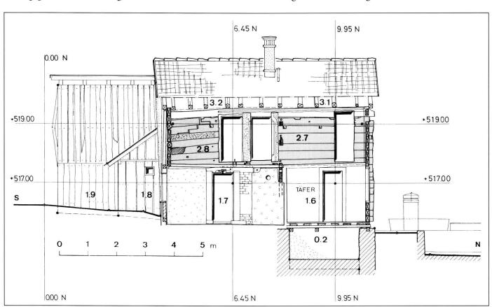
Abb. 4: Ostfassade des Kernbaus. Die ursprünglichen Bauteile sind gerastert.
