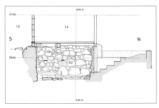
Abb. 28: Untergeschoss, Raum 0.2: Querschnitt und Ansicht der Westwand.
