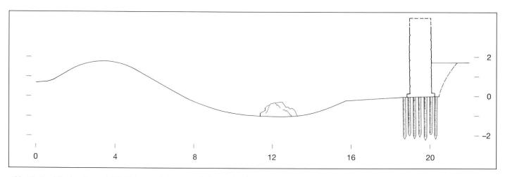
Abb. 12: Letzi Rothenthurm 1999. Rekonstruktionsversuch der Baubabfolge. Legende: **12.1** Aushub des Grabens und Anschütten des Vorwalls. **12.2** Aushub der Baugrube für die Letzimauer. Einrammen der Pfahlgründung. **12.3** Bau der Letzimauer. Verfüllen der Fundamentgrube.
