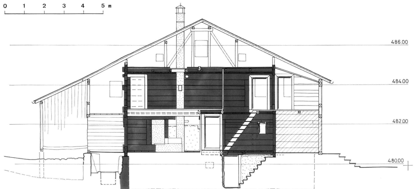
Abb. 12: Ehemaliges Haus «Acher». Nord-Süd-Schnitt mit Ansicht an die Trennwand, die in grossen Teilen zum ursprünglichen Baubestand gehört, Ansicht gegen Osten.
