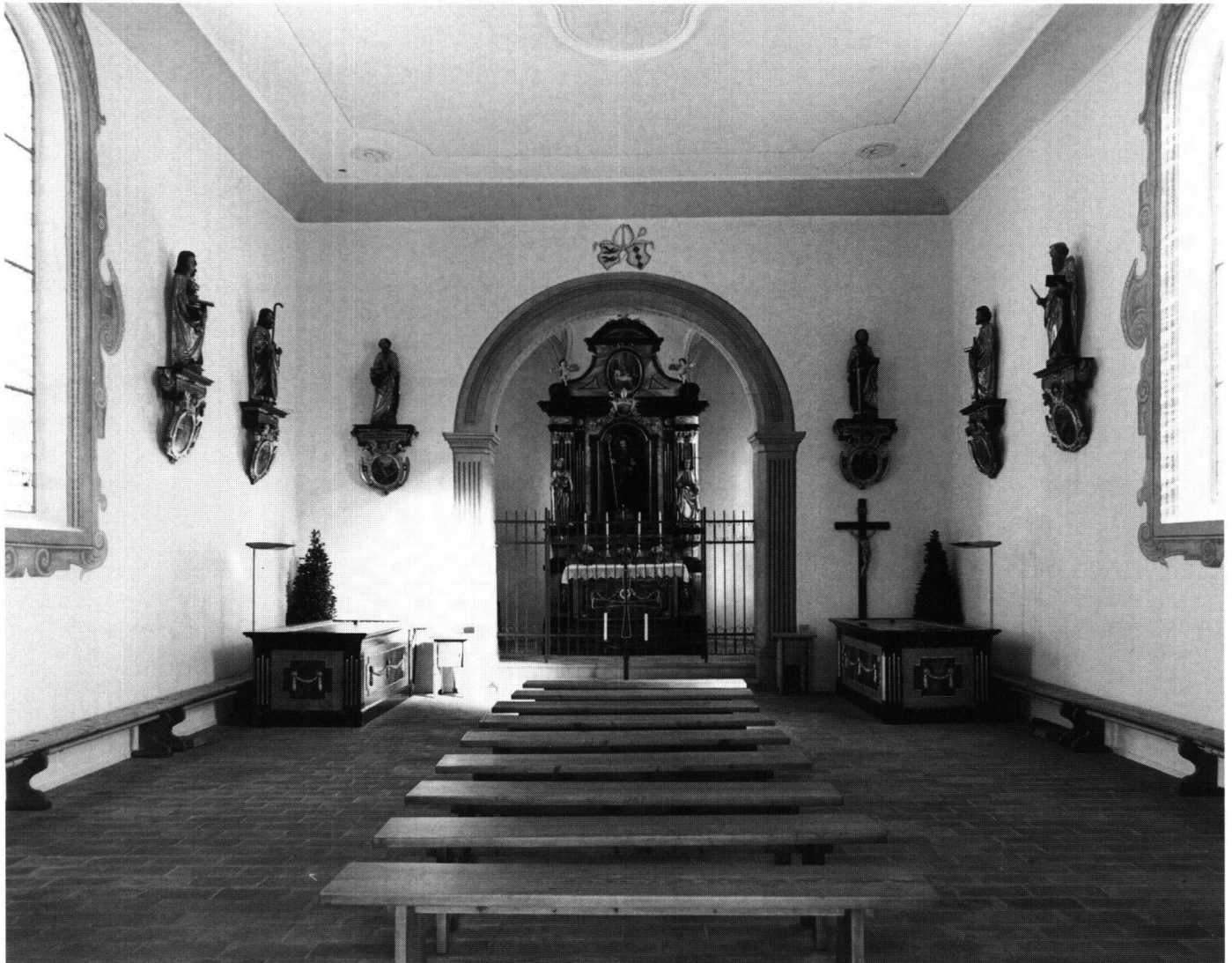
Abb. 15: Einsiedeln, Friedhofkapelle. Obwohl aus unterschiedlichen Zeiten stammend, harmonieren die verschiedenen Malschichten und die um 1800 eingezogene Gipsdecke. Einen wesentlichen Akzent im schlichten Raum bildet die spätgotische Apostelreihe mit barocken Konsolen.
