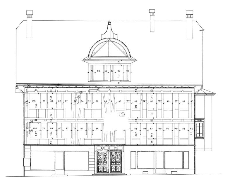
Abb. 8: Schwyz, Haus Gemsch/Weber. Unter der Fassadengestaltung des 19. Jahrhunderts versteckt sich eine ursprünglich auf Sicht konstruierte Fachwerkkonstruktion. In Plan und Photo wurde dieser Zustand festgehalten.
