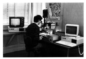
Abbildung 4: Die Messanlage. Die Probe liegt auf einem mobilen Wagen, unter der Binokularlupe. Die Vorwärtsbewegung des Wagens von einer Jahrringgrenze zur anderen, entsprechend der Jahrringbreite, wird gemessen und vom Computer direkt gespeichert. (Aufnahme LRD)
