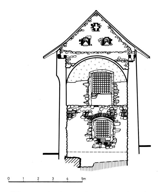
Abbildung 34 Nazareth, archäologischer Aufriß der Nordwand; Maßstab 1: 100. Die engschraffierten Teile sind Umbauten des 19. Jahrhunderts. Die Nordwestecke des Nazareth wurde teilweise auf die Abbruchkrone der mittelalterlichen Klostermauer gestellt.
