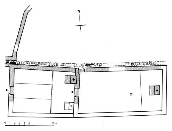
Abbildung 16 Rekonstruierter Grundriß der mittelalterlichen Kirchenanlage des Frauenklosters; Maßstab 1: 300. Die Darstellung zeigt den Zustand der Kirche nach ihrer Fertigstellung um die Mitte des 14. Jahrhunderts mit Ausnahme des Fußbodens in der Westkirche und der Nebenpforte in der Nordwand der Ostkirche, die beide in dieser Weise aus je einem Umbau Mitte des 15. bzw. im 16. Jahrhundert hervorgegangen sind.
