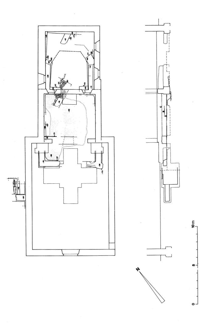
Abb. 48 Gesamtgrundriß und Längsschnitt, 1: 200. A, B. C bezeichnen ältere Böden.
