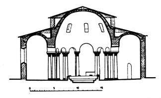
Abb. 9. Baptisterium in Nocera Superiore. Querschnitt (Rekonstruktion).
