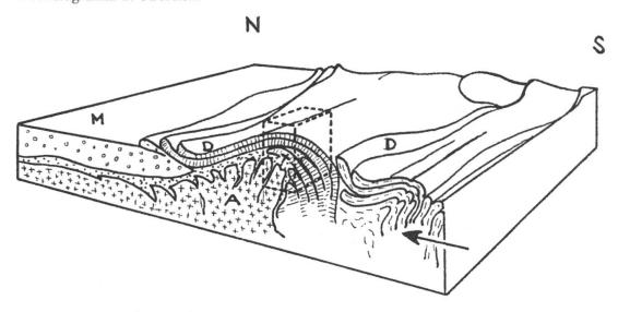
Teile des ehemaligen Ozeanbodens, der ursprünglich zwischen den nun zusammenprallenden Plates lag, werden aufgefaltet und einzelne, umgelegte Falten gleiten als Decken über den eurasischen Kontinentrand.
