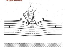
L'elasticità di un pavimento sportivo dipende dalla sua costruzione e dai materiali utilizzati e indica quanto un suolo si deforma sotto una forza puntiforme.
