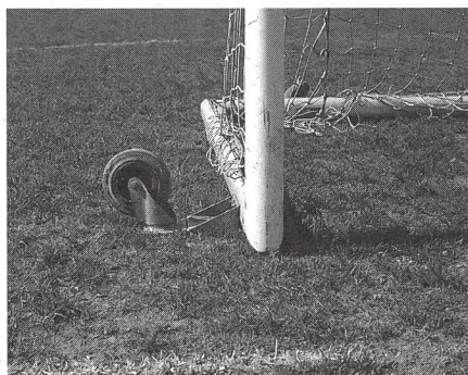
Cattivo esempio: Porte con pericolose rotelle ribaltabili
