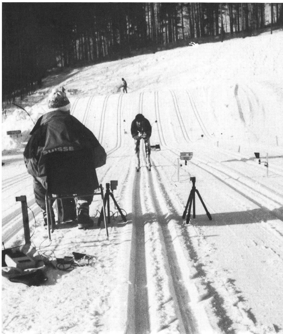
Test di scorrimento: traccia, fotocellule, collaudatore e responsabile del test che redige il protocollo.
