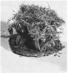
Fibre trasformate dall'usura (diventate fibrille).
