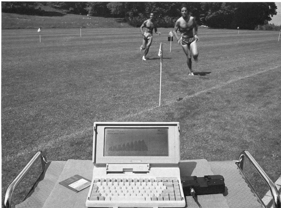
Uno sportivo durante il test. La frequenza cardiaca viene rilevata sul tronco e trasmessa all'orologio (Sporttester PE 3000). I dati vengono immagazzinati e analizzati dall'elaboratore.
