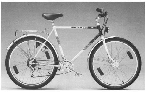
telaio: prevalentemente tubi d'acciaio speciale (cromomolibdene) o aluminio, altezza 49-59 cm
