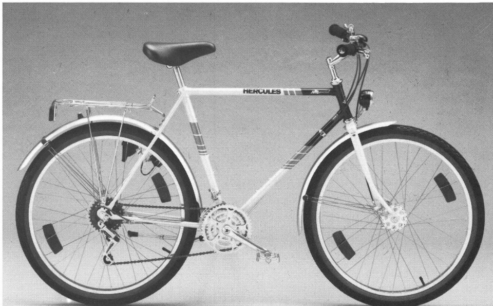
telaio: prevalentemente tubi d'acciaio speciale (cromomolibdene) o alluminio, altezza 49-59 cm
