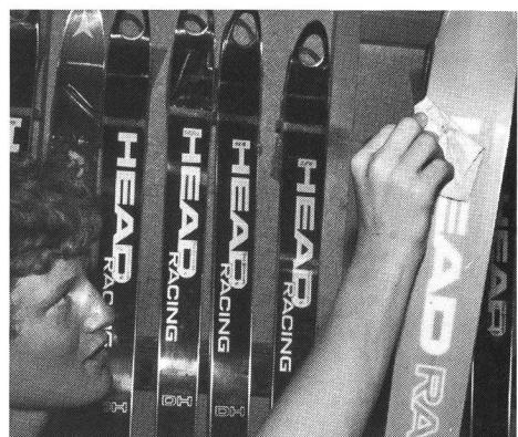
3. Pulite il fondo con uno straccio e il diluente. Passate quindi a sciolinare il fondo. Perchè si dovrebbero sciolinare gli sci dopo ogni uscita sulla neve, o almeno ogni 2-3 volte?
