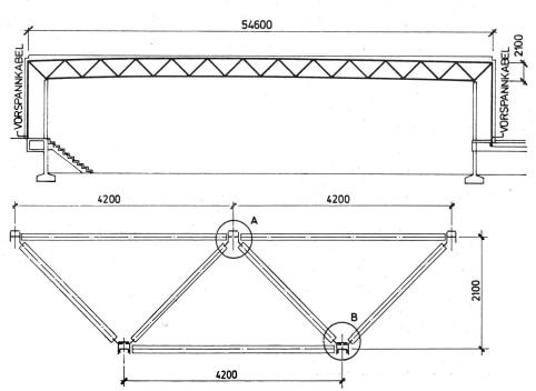
Sistema portante delle capriate. I cavi di tensione (Vorspannkabel) tirano le estremità verso il basso scaricando la zona centrale.
