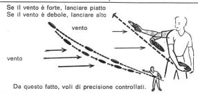
Sport aeronautico: il Frisbee funziona con il principio girostatico e con le stesse forze di sostenimento che agiscono su una superficie portante d'aereo.
