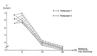
Fig. 4: influsso del carico sulla velocità tangenziale.
