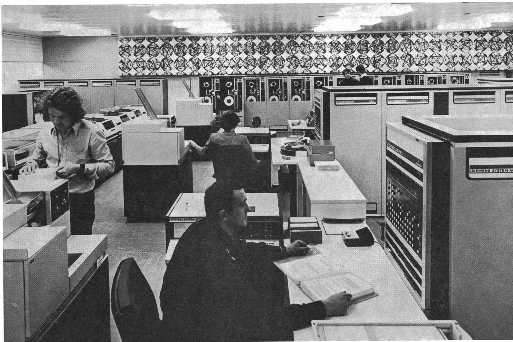
Il calcolatore olimpico. Durante i Giochi, son giunti a questo centro di calcolo tutti i dati relativi a tutte le competizioni, che si sono svolte in 31 luoghi diversi. Il calcolatore ha ordinato questi dati in brevissimo tempo, per ritrasmetterli, mediante telescriventi, a tutti i centri-stampa dislocati tra Monaco e Kiel. L'elaboratore non ha trasmesso automaticamente solo il piazzamento dei concorrenti, ma ha anche segnalato la qualificazione eventuale degli atleti per la prova successiva, preparato un grafico per gli accoppiamenti negli incontri di pugilato, judo, lotta, scherma, ecc., ed emesso un segnale speciale ogni volta che è stato stabilito un nuovo primato olimpico o mondiale.
