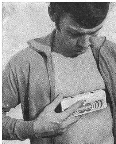
Tre elettrodi fissati su di una cintura captano i battiti del cuore alla superficie del torace e li trasformano elettronicamente in un segnale acustico («piepton»), facilmente udibile anche durante l'azione. Grazie a due preselettori, si può regolare un intervallo di frequenza, durante il quale i segnali non sono più percettibili. I limiti inferiori che si possono scegliere sono di 90, 100, 110 o 120; quelli superiori sono di 150, 160, 170 o 180.
