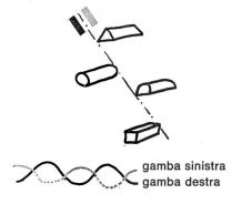
Un altro mezzo di costruzione consiste in resti di assi, ai quali vengono fissati due picchetti. Essi vengono piantati facilmente e si può completare da ogni parte la costruzione con la neve; ciò non domanda molto tempo. Vantaggio: quando cade neve fresca, o nel momento dello sciogliersi della neve, si può procedere ad un adattamento facile alle nuove condizioni.
