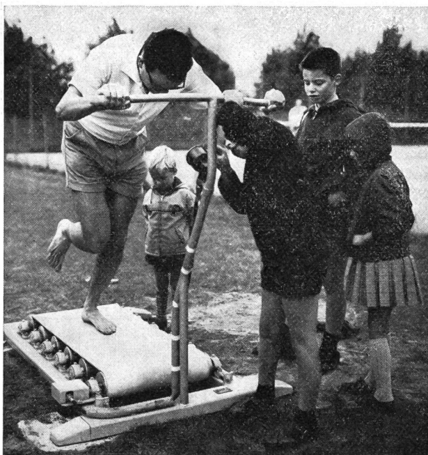
Nastro scorrevole: un tachimetro mostra la velocità e il tratto percorso in un minuto (test di resistenza)
