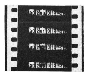
Ecco una riproduzione del film impressionato in 4 secondi dalla cellula fotoelettrica della «Cronocamera Longines» sul quale si possono leggere 12 numeri che, da sinistra a destra, indicano: i primi due l'ordine di partenza, i tre seguenti l'ordine di arrivo, il sesto le ore, i due seguenti i minuti primi, il nono e il decimo i minuti secondi e gli ultimi due i centesimi di secondo! (Foto: Aldo Sartori)
