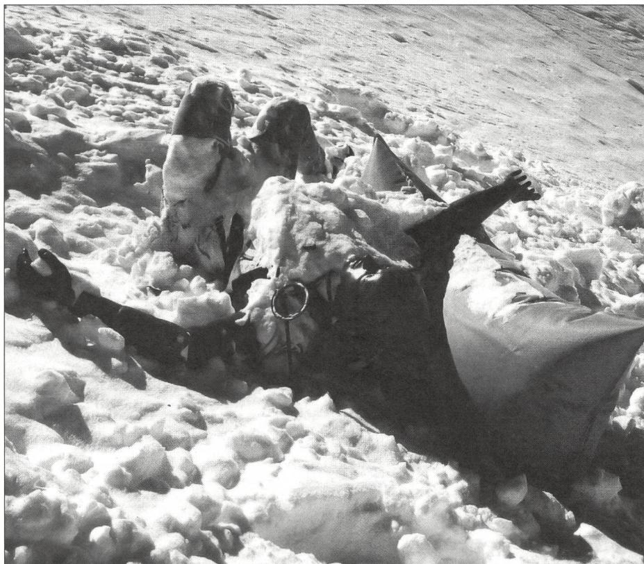
**L'Institut fédéral pour l'étude de la neige et des avalanches (ENA) au Weissfluhjoch sur Davos a réalisé les premiers essais avec le ballon avalanche ABS à la fin de l'hiver 1994/95. Ces derniers permettent de conclure provisoirement que ce système peut avoir des répercussions positives sur la technique de sauvetage.**
