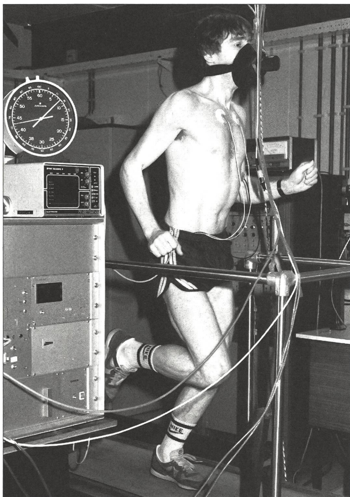
Détermination de la consommation maximale d'oxygène et enregistrement de la fréquence cardiaque pendant un test au simulateur de course en accélération progressive.
