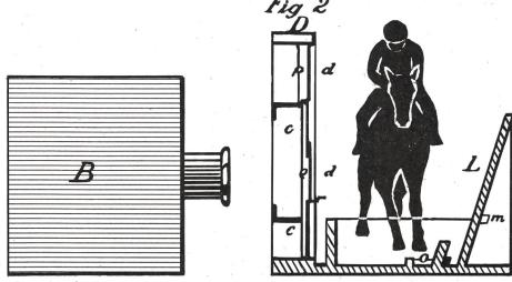
Extrait du brevet (1878–1879) de E. J. Muybridge montrant le principe de déclenchement d'un appareil par la rupture d'un fil. (L'adjonction du cheval n'est pas d'origine.)
