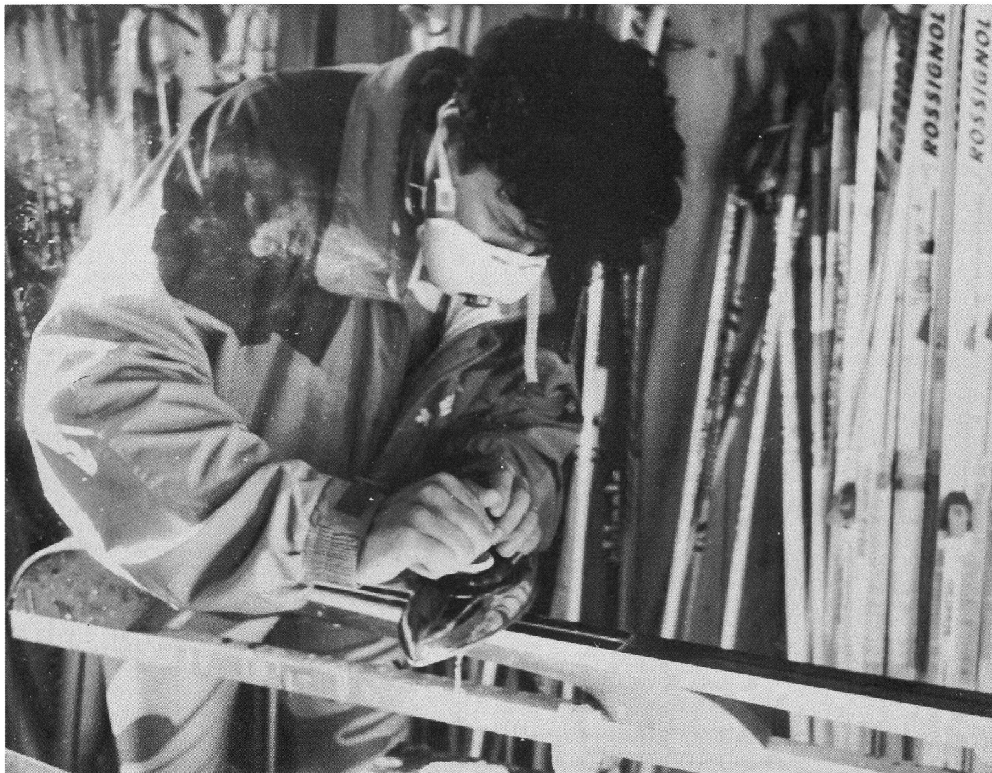
Lissage de la semelle au fer chaud: les farts de glisse modernes en poudre provoquent des vapeurs désagréables.
