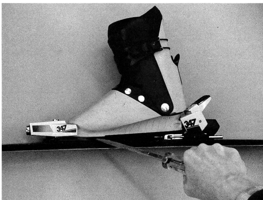
Contrôle du jeu sous le serre-semelle de la butée.
