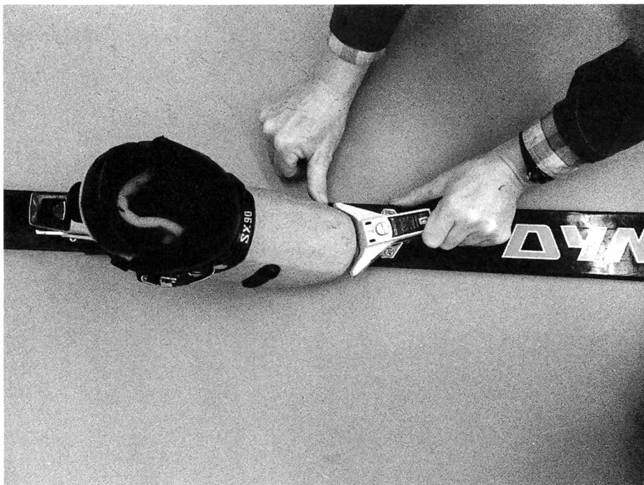
Contrôle de l'élasticité latérale.
