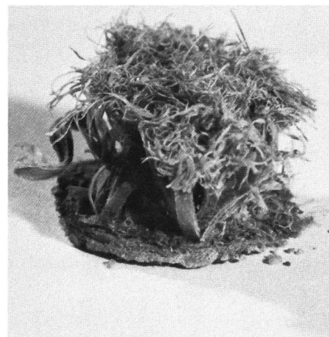
Fibres transformées par l'usure (fendues et formant, ainsi, une multitude de fibres très fines).
