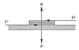
Un frottement s'oppose aux forces qui provoquent ou tendent à provoquer le glissement d'un corps sur un autre.
