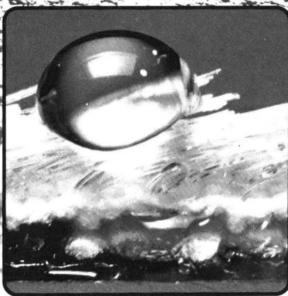
Les fibres nylon sont hautement hydrophobes, c'est-à-dire réfractaires à l'eau. De ce fait, même dans des conditions extrêmes, les peaux Montanyl ne craignent ni le givrage, ni la formation de sabots.
