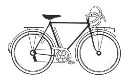
La bicyclette sera un modèle de randonnée. Elle est de bonne qualité et elle doit permettre de rouler sans fatigue et d'être bien sur tous les chemins. Elle a des pneus, plus résistants que les boyaux. Pour les longues randonnées, elle est équipée d'un porte-bagages à l'avant et à l'arrière et, dans tous les cas, d'une source d'éclairage en état de marche. Un vélo à la taille de chaque équipier: voilà une règle essentielle, tout comme celle qui veut que l'on préfère les
