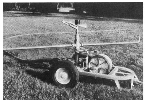
Tourniquet monté sur chariot (débit moyen)
