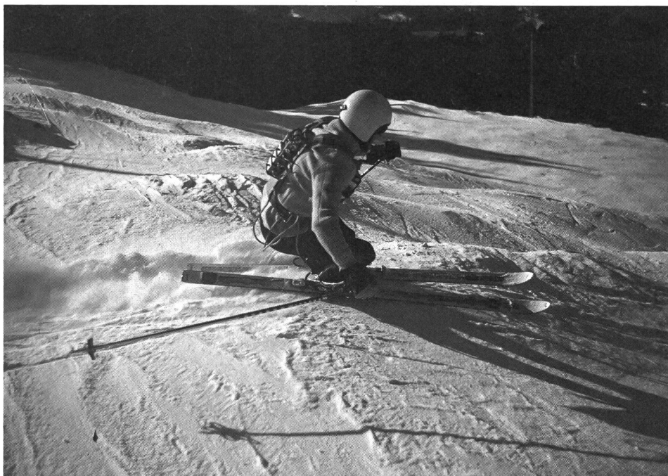
Les recherches en vue d'améliorer la conception des skis passent maintenant par l'identification précise de leur travail sur la neige. Pour cela, on les équipe de jauges de contraintes (mesure des déformations superficielles) ou d'accéléromètres (mesure des chocs) dont les signaux sont enregistrés sur bande magnétique. Sur la photo, l'essayeur porte l'enregistreur sur la poitrine et dans le dos, l'alimentation et les amplificateurs.
