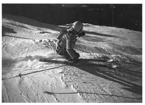
Les recherches en vue d'améliorer la conception des skis passent maintenant par l'identification précise de leur travail sur la neige. Pour cela, on les équipe de jauges de contraintes (mesure des déformations superficielles) ou d'accéléromètres (mesure des chocs), dont les signaux sont enregistrés sur bande magnétique. Sur la photo, l'essayeur porte l'enregistreur sur la poitrine et dans le dos, l'alimentation et les amplificateurs.
