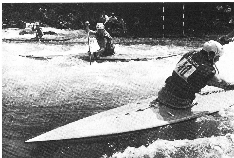
Les canadiens de compétition en eaux vives sont pontés et se sont développés ces derniers temps pour ressembler de plus en plus aux kayaks. Aujourd'hui, il n'y a plus guère de différences quant à leur forme (canadien monospace de slalom lors d'une course par équipes).
