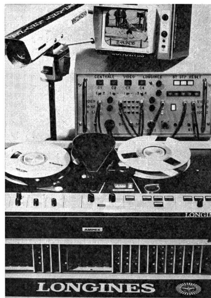
Complexe Vidéo-Longines: enregistrement électronique des images d'arrivées à raison de 100 images à la seconde, soit une image chaque \frac{1}{100} de seconde. Cette installation sera engagée par Swiss Timing dans le contrôle d'arrivées des épreuves par équipes en ski nordique.
