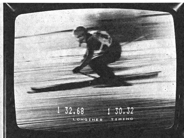
Chronométrage et information télévisée — La performance chronométrée est intégrée à l'événement grâce aux générateurs de symboles numériques développés par les techniciens de Swiss Timing. (Photo Longines)
