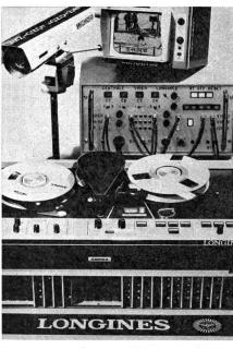
Complexe Vidéo-Longines: enregistrement électronique des images d'arrivées à raison de 100 images à la seconde, soit une image chaque 1/100 de seconde. Cette installation sera engagée par Swiss Timing dans le contrôle d'arrivées des épreuves par équipes en ski nordique. (Photo Longines)
