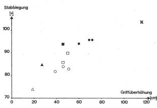
Fig. 5: Der Einfluss der Stabbiegung  $\eta$  auf die Griffüberhöhung
