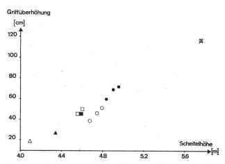
Fig. 4: Der Einfluss der Griffüberhöhung H<sub>SG</sub> auf die Scheitelhöhe H<sub>S</sub>
