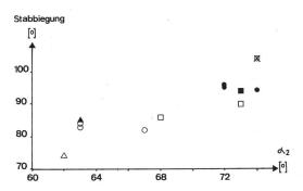
Fig. 12: Der Einfluss der Stabbiegung  $\eta$  auf den steilsten KSP-Bahnwinkel  $\alpha$  2
